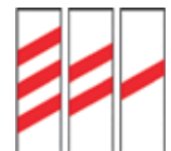
1.17 Panneaux indicateurs de distance 3/3 - 2/3 - 1/3
