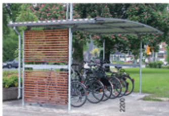
Abri unilatéral, paroi latérale en lamelles de bois, toiture en profilés de tôle d'acier.
