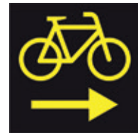
5.18 Signal autorisation aux cycles de tourner à droite lorsque le feu de signalisation est au rouge
